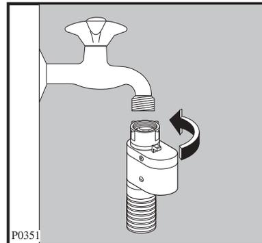
Wenn der an der Rückwand bereits montierte Wasserzulaufschlauch nicht lang genug ist, sollte dieser durch den Kundendienst ausgetauscht werden. Die verwendeten Zulaufschläuche mit Wasserstopp-Ventil müssen für einen Arbeitsdruck von mindestens 10 bar ausgelegt und VDE geprüft sein. Dies entspricht einem Berstdruck von 30 bar.
